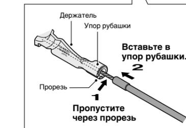
Если легче сначала вставить рубашку в упор, то вставьте сначала рубашку в упор, затем вставьте шестигранный на 2 мм или спицу №14 в отверстие на барабане замка звезды и после этого поверните барабан, так чтобы фиксирующий винт сел в гнездо на барабане.
