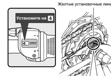
Желтые установочные линии на замке звезды находятся в двух местах. Используйте ту, которую легче видеть.
